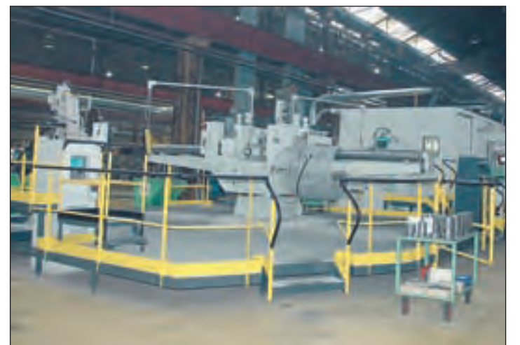
Cette presse de dernière génération débite une à deux pièces par seconde.
